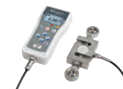
Anwendungsbeispiel mit externer Messzelle
