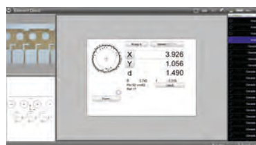
Einzelelementansicht mit grafischer Darstellung der Messpunkte
