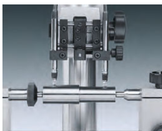
Differenzmessungen mit ungleicher Polarität (+A -B): Erfassen von Form- und Lageabweichungen, wie z.B. von Rundlaufabweichungen mit Speicherfunktion „max-min“
