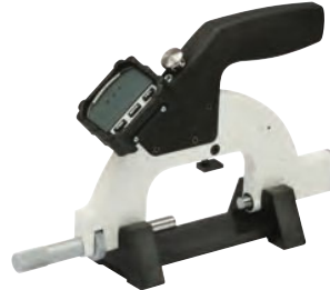
Digitalpassameter in Geräteablage
