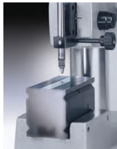
Summenmessungen mit positiver Polarität (+A +B): Messen von Außenmaßen, unabhängig von Form- und Lageabweichungen
