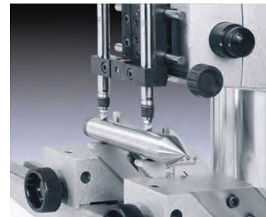
Differenzmessungen mit ungleicher Polarität (+A -B): Anwendung für Stufen-, Kegel- und Neigungsmessungen
